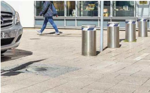
Bild 1: Poller (gibt es als feststehende, abklapp- bzw. herausnehmbare, halb- und vollautomatische Modelle)
