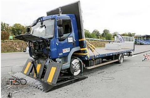
Bild 2: ausfahrbarer Roadblocker
